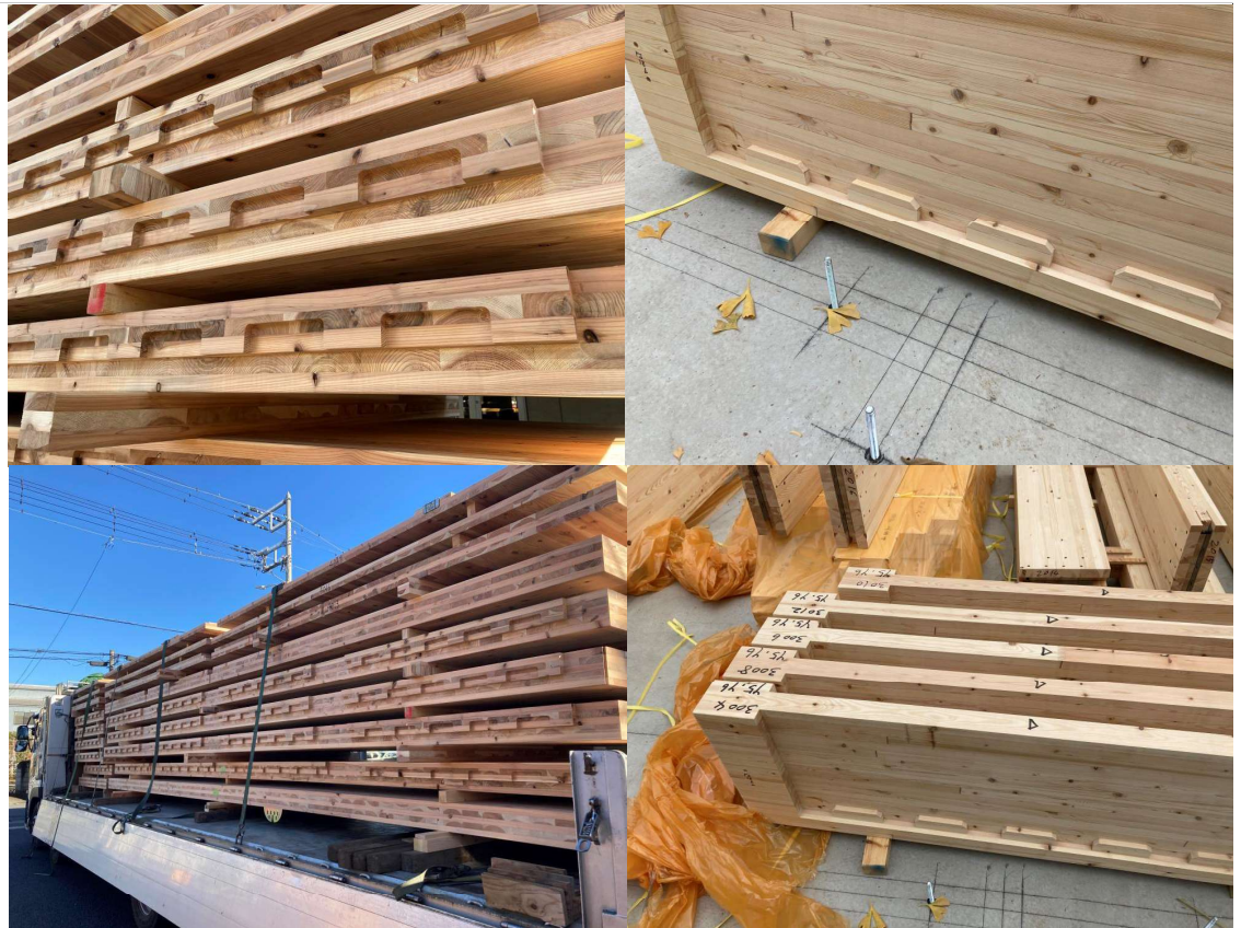
集成梁とCLTスラブの加工断面
