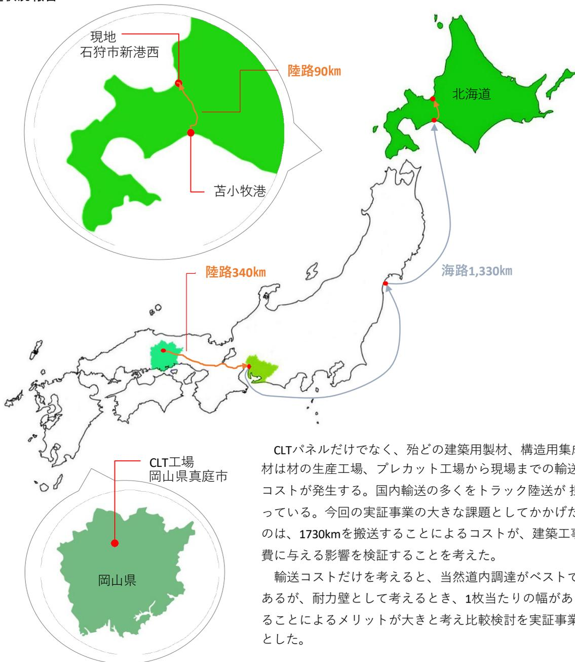
CLTパネルだけでなく、殆どの建築用製材、構造用集材材は材の生産工場、プレカット工場から現場までの輸送コストが発生する。国内輸送の多くをトラック陸送が担っている。今回の実証事業の大きな課題としてかかげたのは、1730kmを搬送することによるコストが、建築工事費に与える影響を検証することを考えた。
