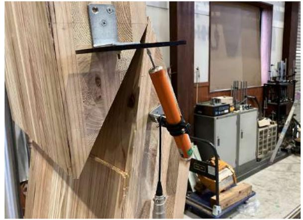
图 1.2 接合部側面 (引張実験 最終破壊状況)
