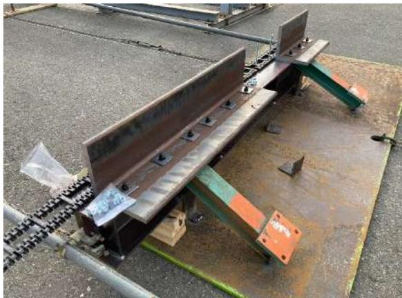
図19 検証実験用支圧プレート
