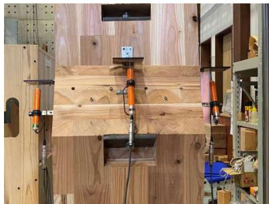
図 9 変位計設置位置 (左 : ch 1 中央 : ch 2 右 : ch 3)
