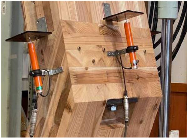
图 1.1 接合部 (引張実験 実験前)
