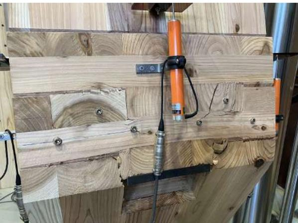
图 1.7 接合部 (圧縮実験 最終破壊状況)
