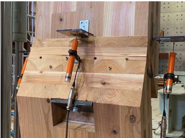
图 1.3 接合部 (引張実験 最終破壊状況)
