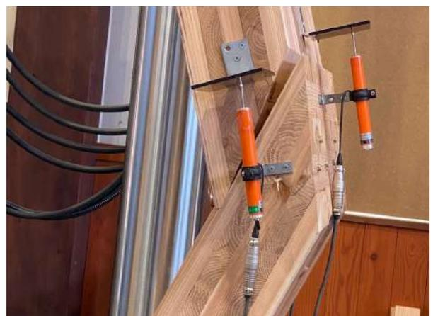
图 1.6 接合部側面 (圧縮実験 最終破壊状況)
