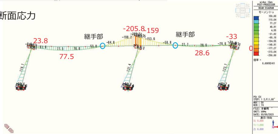
○解析結果 Y方向 (鉛直力負担幅3m時) 継手部分 ピン
