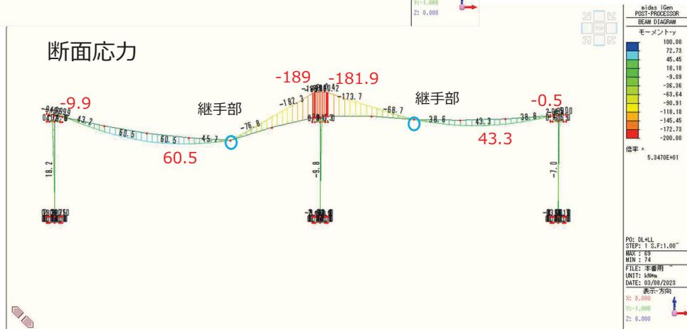
○解析結果 Y方向 (水平力負担幅3m時) 継手部分 ピンなし
