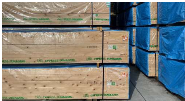
② 養生し保管される乾燥材
