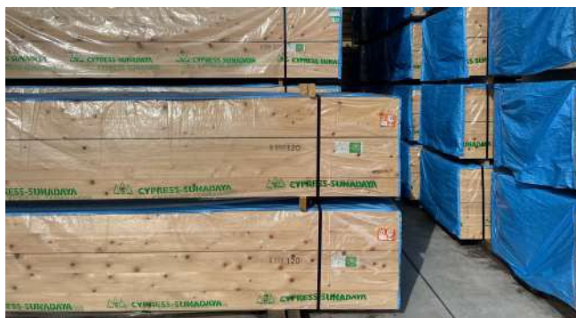
② 養生し保管される乾燥材
