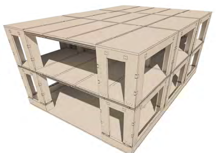
RF CLT 大板設置 躯体完了
