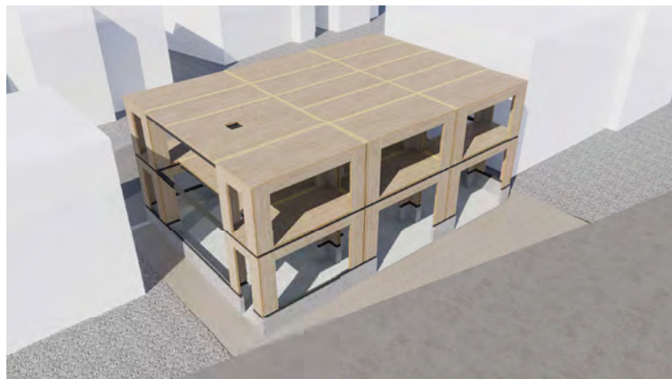
②鉄骨梁 /CLT 床スラブ設置 構造躯体完了
