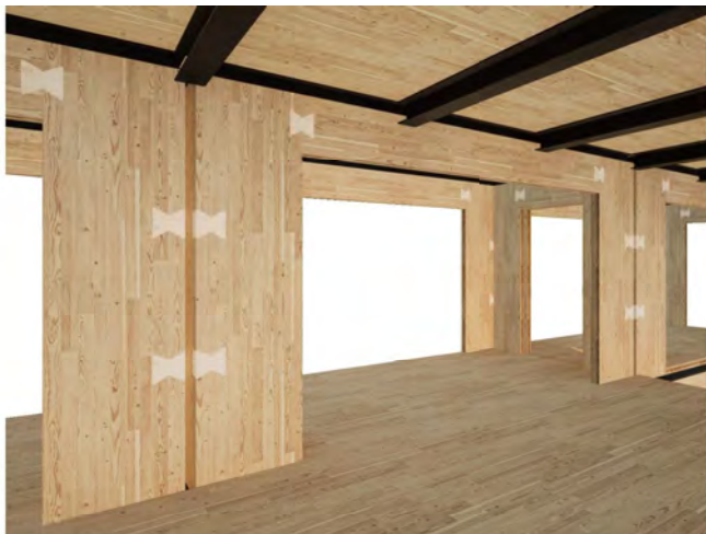
Unit 上部に鉄骨追加
