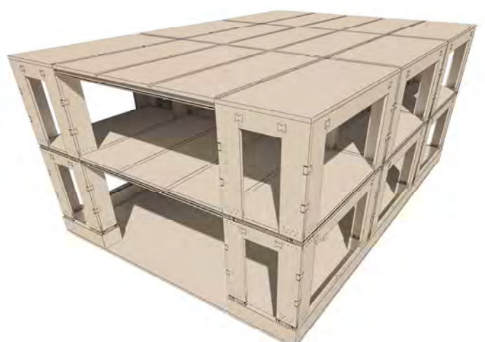
RF CLT 大板設置 躯体完了
