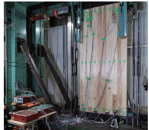
性能試験の様子（静加力実験）
