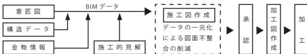
図 4 0 理想的な CLT 加工までのフロー
