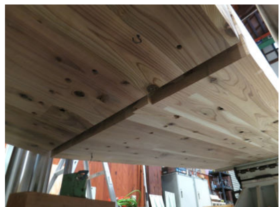
図 2-5 最終加力時の接合部 (B-1)
