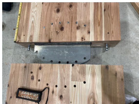
図 3 3 CLT パネル同士の取り付け（正面）
