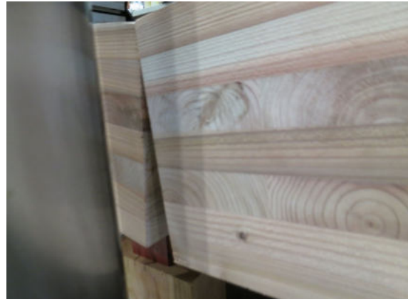
図 1 3 最終加力時の接合部 (A- 1)
