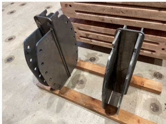
図 2 8 面外曲げ接合金物
