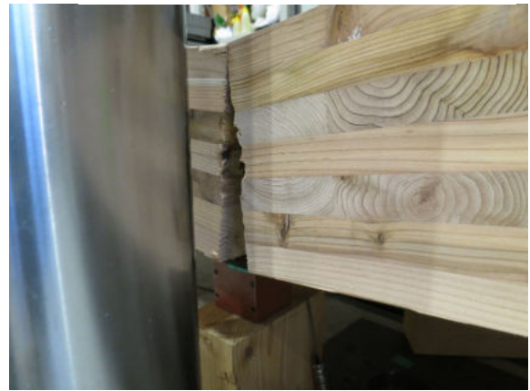
図 1 7 最終加力時の接合部 (A- 2)
