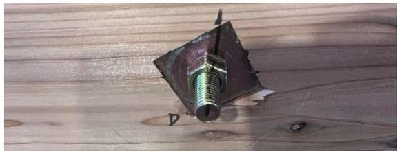
図 11 座金のめり込み状況 (Type A2, 荷重後)
