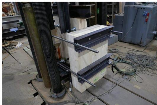
図 3.3 VGS9440 せん断試験体設置写真
