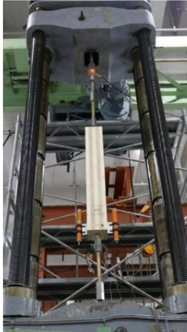
図 5.3 タフネスコネクタ引張試験体設置写真
