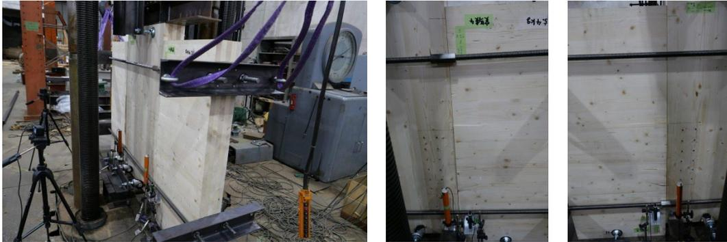
図 4.6 破壊性状（試験体 No.3）
