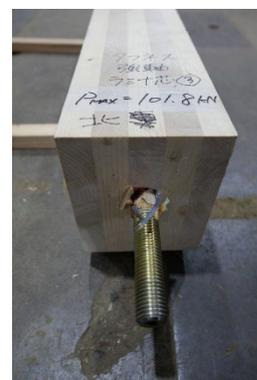
図 5.5 タフネスコネクタ平行層ラミナ芯 左：荷重変形曲線 右：破壊性状
