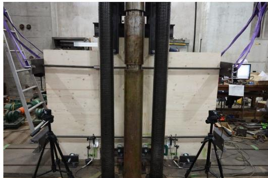
図 4.3 ALUMAXI せん断試験体設置写真
