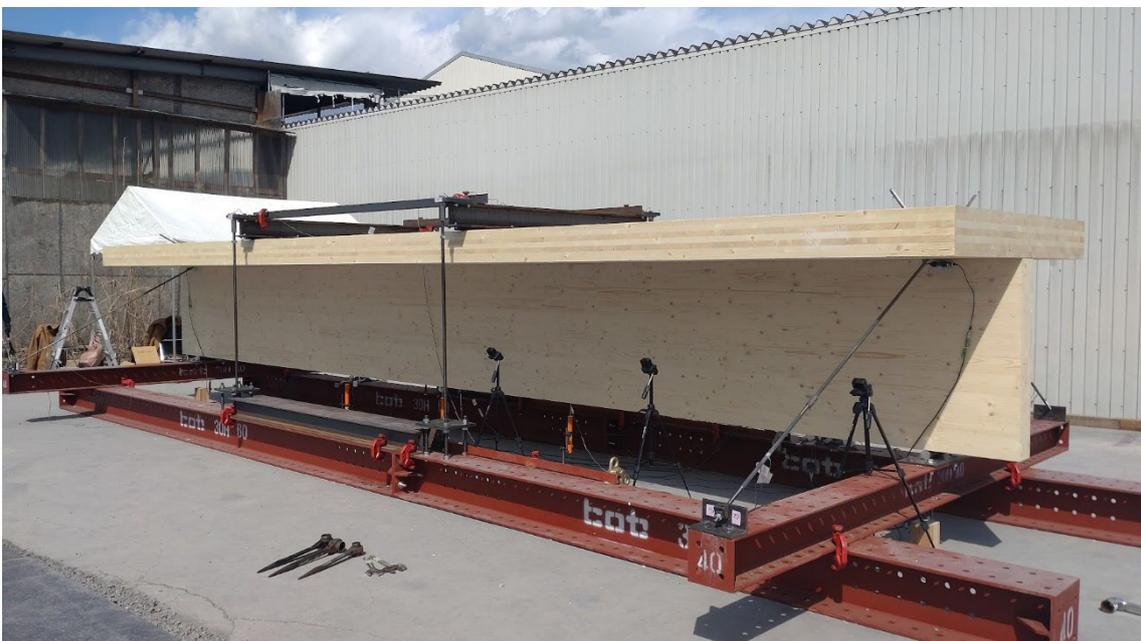
図 2.4 T 形梁曲げ試験 試験装置全体写真
