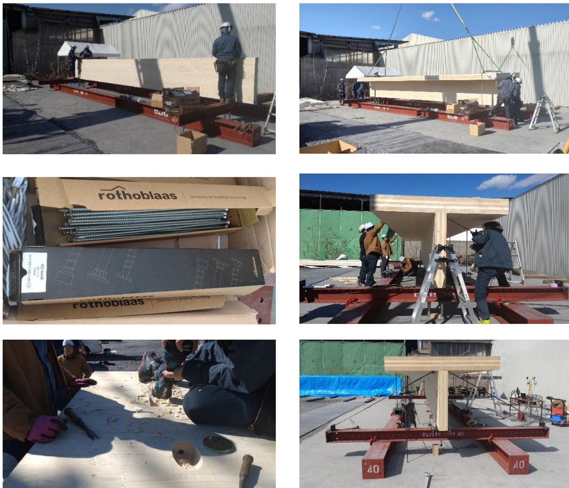
図 2.3 T形梁曲げ試験 組立写真
