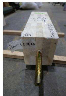
図 5.8 ホームコネクター直交層 左：荷重変形曲線 右：破壊性状
