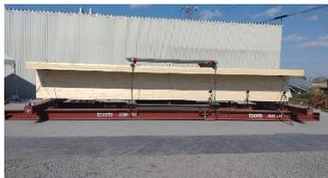
図 1 T 形梁試験体
