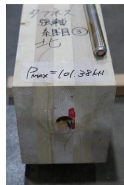
図 5.6 タフネスコネクター平行層ラミナ継目 左：荷重変形曲線 右：破壊性状
