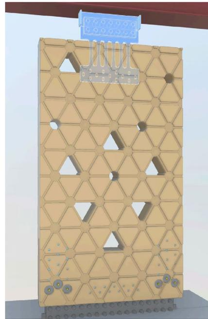
図 1.3-2 構造パース (CLT 付加制振壁)
