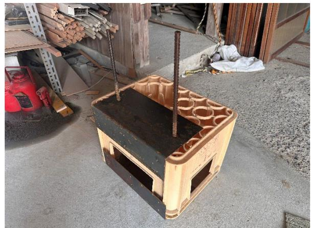
図 4.2-8 アンカーボルトセットテンプレート②
