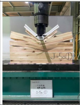
各部材_めり込み破壊
