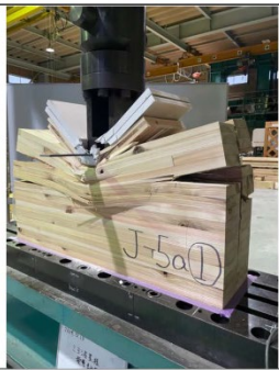
各部材_めり込み破壊
