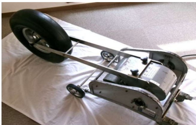
重量床衝撃源（バングマシン）洋室201
