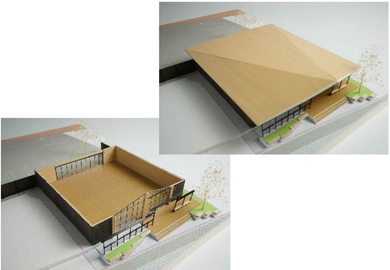
写真1)-1 CLT パネルで構成した外壁と屋根
