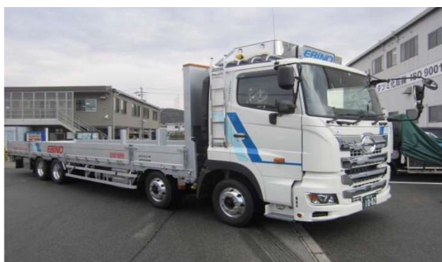
図 4-1 本計画で設計したモジュールを運搬可能なトラックの例（15 トン平超低床車）
