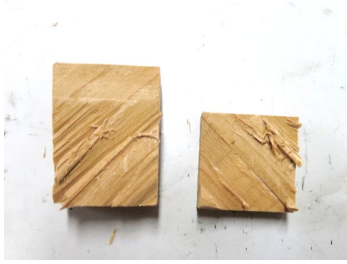
写真 3-4-3 繊維の一部が残存した破断
