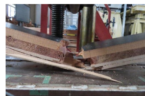
写真 3-4-13 全断面の破断
