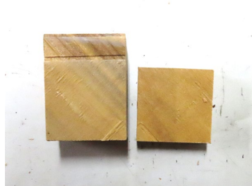
写真 3-4-4 接着層近傍の平滑破断面
