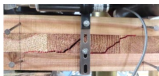
写真 3-4-17 ローリングシア破壊
