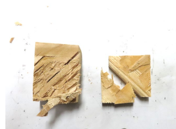
写真 3-4-5 載荷側材の破断
