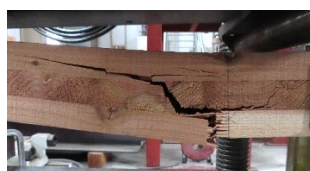
写真 3-4-10 曲げ破壊発生後のローリングシア破壊
