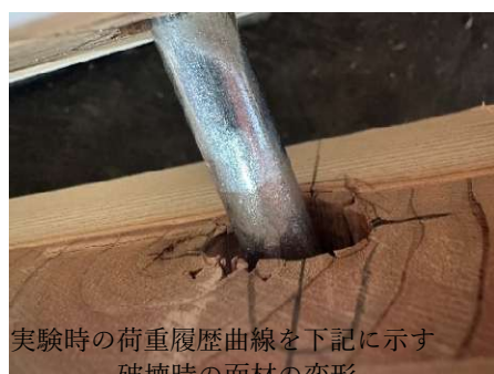
図 4.1-4 隠しダボ破壊状況写真
