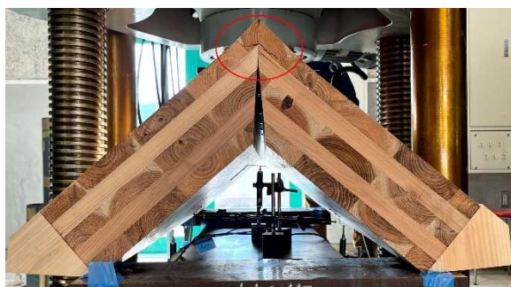
図 9 試験体 (Type B2) の変形と CLT パネル割裂破壊の状況 (赤丸部)
