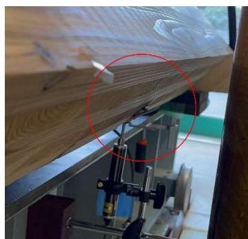
図 8 開き止め接合部周辺の破壊状況 (Type A1)
