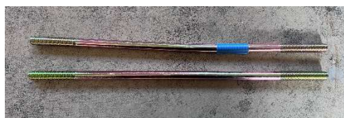
図 10 荷重後試験体の六角ボルト (上) と未使用の六角ボルト (下)
