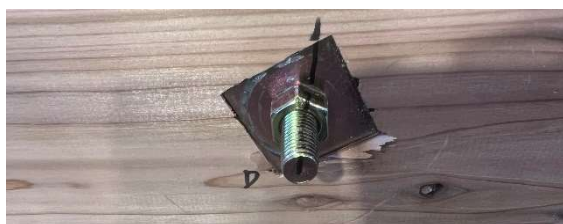
図 11 座金のめり込み状況 (Type A2, 荷重後)
