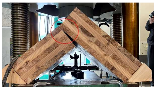
図 6 試験体 (Type A1) の変形状と CLT パネル接合部ラミナ内の割裂破壊 (赤丸部)
